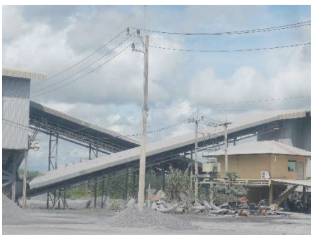
รูปที่ 2-33: การปิดคลุมสายพานลำเลียง
