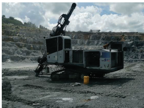
รูปที่ 2-15: รถเจาะรูระเบิดที่มีเครื่องจับฝุ่น
