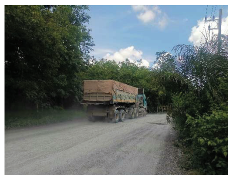
รูปที่ 2-20: การปิดคลุมผ้าใบรถบรรทุกแร่
